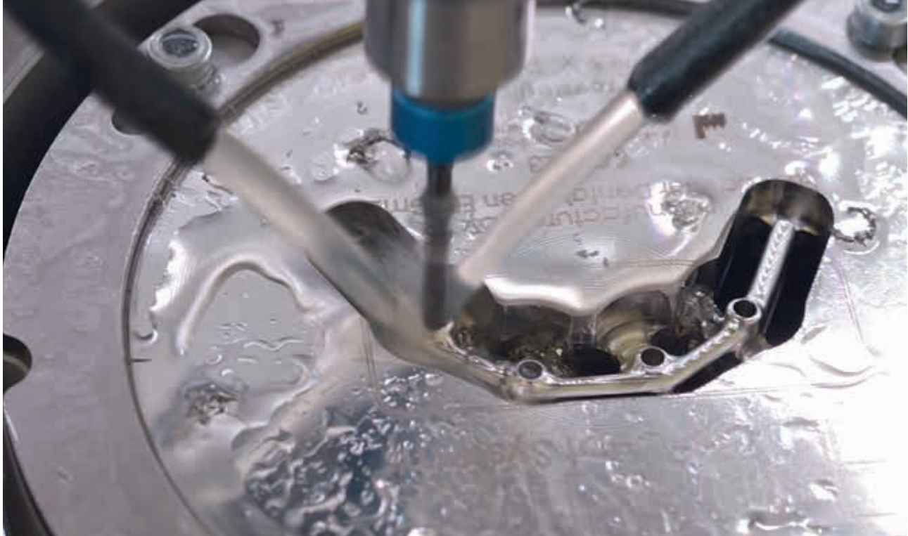
CNC-Fräsen eines zahntechnischen Werkstücks
