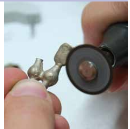
Trennen der Gerüstkrone a.6
